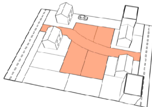
Fig. 8 - Voie maillante créée à l'occasion d'une opération de construction
